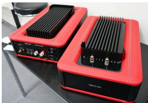
▲ ABSOLARE功放的顶级皮革包覆外观很好辨认，不过大都是同一种褐色款。今年这部HYBRID MONO AMPLIFIER单声道后级，机箱先以3mm厚铝板焊接后再包覆高密度板，最后再辅以显眼的赤红色皮革，目的不单单是为了好看，也是为复合材质减震考虑
