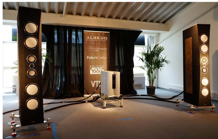
▲ 意大利品牌ALBEDO带来搭载钻石高音的最新旗舰ATESIA扬声器（开价118,000欧元），依旧搭载传输线低音设计、陶瓷振膜单元及时间相位分频网络；现场使用美国VTL S-400 SERIES II立式胆后级驱动，实际上是旗舰SIEGFRIED的立体声版本
